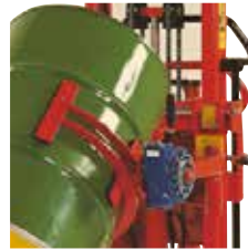
El sistema "Quick Shift" hace posible un cambio rápido de un implemento a otro.
